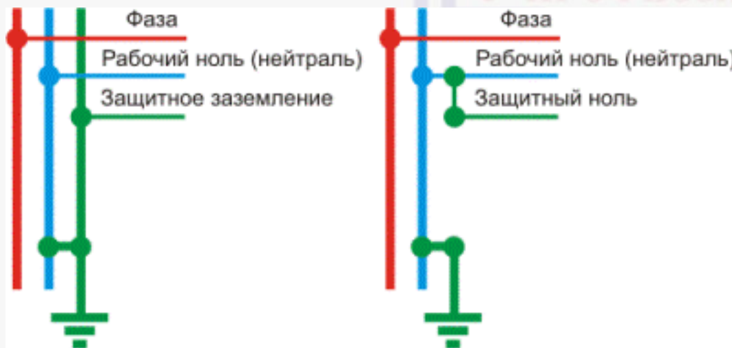
Рис. 23. Отличие защитного заземления от защитного «нуля»
